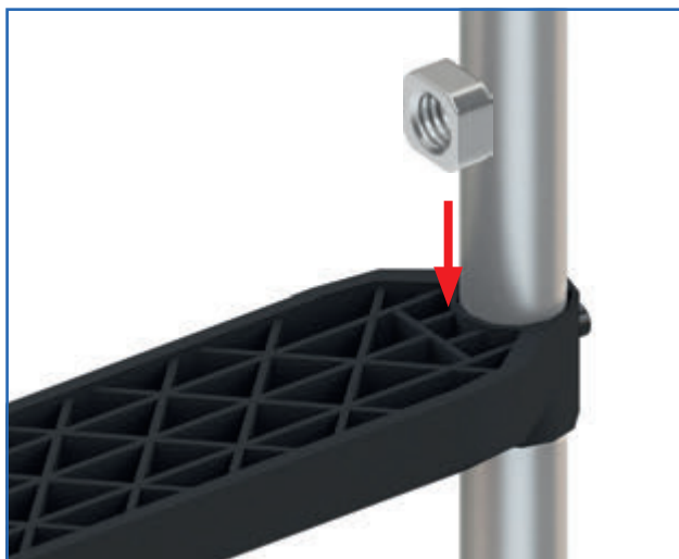
Abb. 2: Verschraubung der Stufen (die Leiter steht dabei auf dem Kopf)
