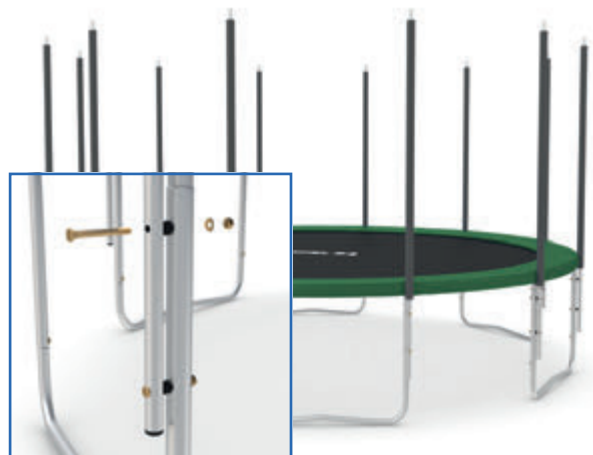
Abb. 4: Fixation des montants du filet
