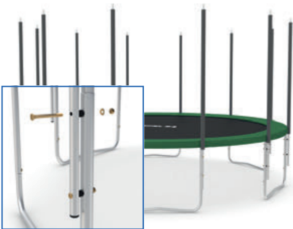
Abb. 4: Befestigung der Netzpfoستen
